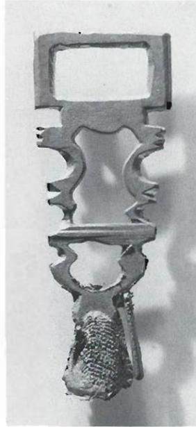
Abb. 6 Das fertige Gußstück mit „Gußkönig“ und ausgefüllten Luftkanälchen sowie feinen Gußresten an den Kanten. Maßstab 1:1.
