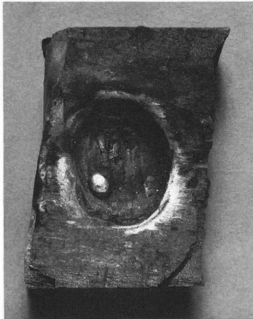
Abb. 5 Der aus einem Holzkohlestück herausgearbeitete Schmelztiegel mit einem Rest der Zinn-Kupfer-Schmelze. Maßstab 1:1.
